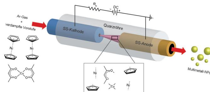
**Unter Volldampf:** In einer plasma-basierten Route zu multimetallischen Nanopartikeln (NPs) werden Mischungen verdampfter metallorganischer Verbindungen in einem Mikroplasma bei Atmo-
